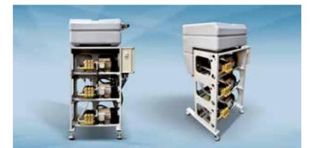
Disponemos de racks de electrobombas para el lavado a alta presión a 70 bar y 126 L/min, con una potencia total de 11 o 16,5 kW, compuestos respectivamente por 2 o 3 electrobombas de 70 bar a una potencia de 5,5 kW. Incluyen un depósito de agua de 200 L en posición elevada para alimentar correctamente las electrobombas y una válvula by-pass con regulador de presión. Su filtro de entrada de 100 micras protege las electrobombas y evita la obturación de las boquillas.
